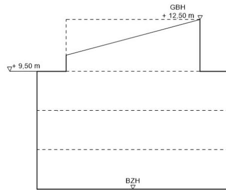
Geneigtes Dach mit  $DN = 35^\circ - 45^\circ$
